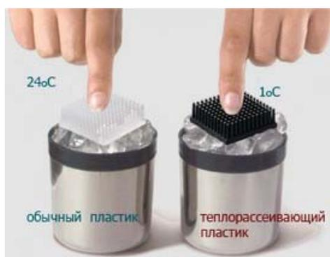
*Рис. 1. Сравнение эффективности отвода тепла у теплопроводящих и обычных пластмасс [3]*
