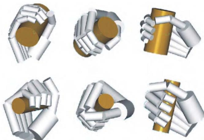
*Рис. 7* Различные положения геометрической модели руки, которые использовались в работе *Sancho-Bru et al. (2003)*, для того чтобы смоделировать зажим цилиндров различных диаметров [13]
