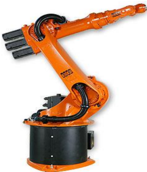
Рис.1 Общий вид ПР “KUKA” стационарного напольного исполнения
