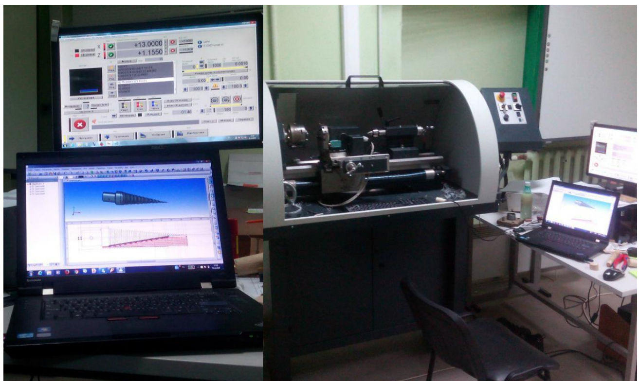
Рисунок 4. Рабочее место у станка с ЧПУ WABECO D6000
