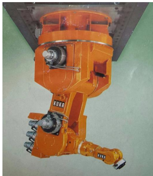
Рис.2 Общий вид ПР «KUKA» подвесного тельферного типа перемещающийся по монорельсу
