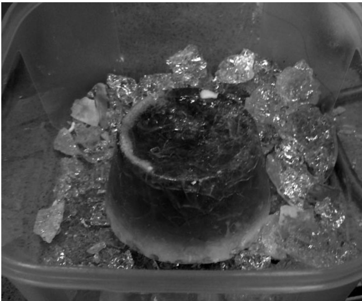
Рисунок 1. Образец полученного стекла с маркирующим соединением
