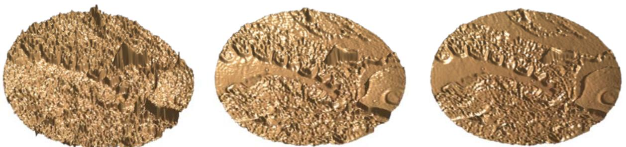
Рисунок. 2 Эволюция качества восстановленного изображения фазового профиля микрообъекта по мере накопления информации с разных спектральных компонент. (а) – 1 спектральная компонента, (б) – 25 спектральных компонент, (в) – 50 спектральных компонент.
