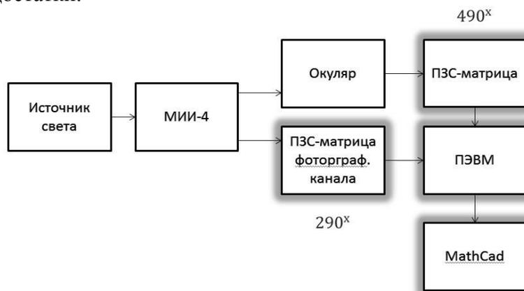
Рисунок 1 – Блок-схема комплексного применения ПЗС-матрицы и программы MathCAD
