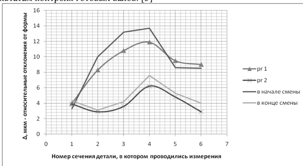
Рис. 1 Нейропрогнозирование изменения формы и размеров деталей во времени
