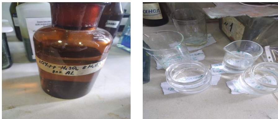
Рис. 3. Образцы, помещенные в различные химические реагенты (HCl, H 2 SO 4 , пропанон-2, H 2 O, этиленгликоль)
