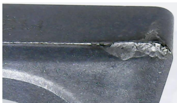
Рис. 2.Г. Износ пластины после обработки 15 режимом обработки, изометрия
