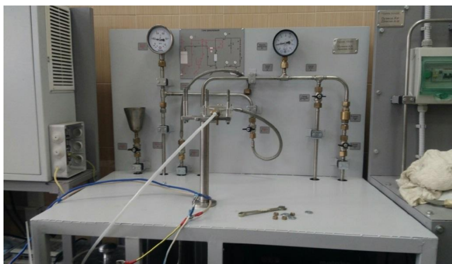
Рис. 4. Установка для электрохимической обработки
