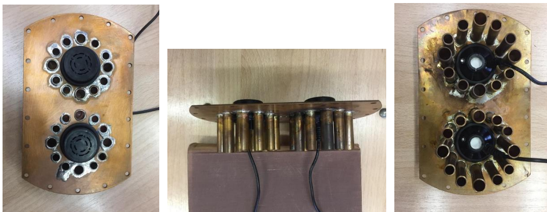
Рис. 1. Колпачковая тарелка с добавлением источника УЗ-колебаний
