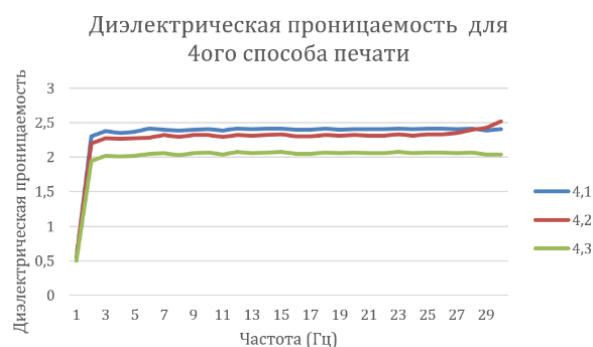
Рис. 7. Зависимость диэлектрической проницаемости от частоты для 4 способа печати
