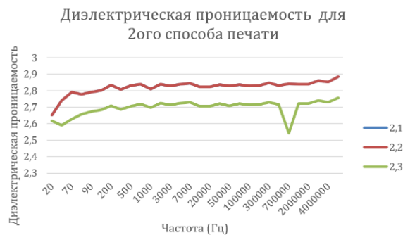
Рис. 5. Зависимость диэлектрической проницаемости от частоты для 2 способа печати
