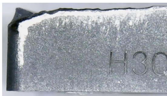
Рис. 4.В. Износ пластины после обработки 24 режимом обработки, вид сбоку
