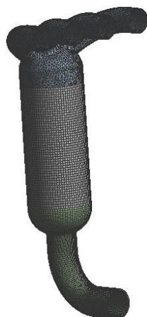
Рис. 2. Сетка конечных элементов корпуса каталитического коллектора
