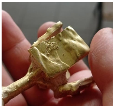
Рис. 2. Отливка, полученная по экспериментальной формовочной смеси
