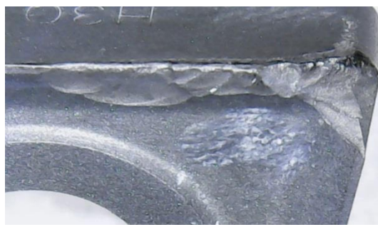
Рис. 4.Г. Износ пластины после обработки 24 режимом обработки, изометрия
