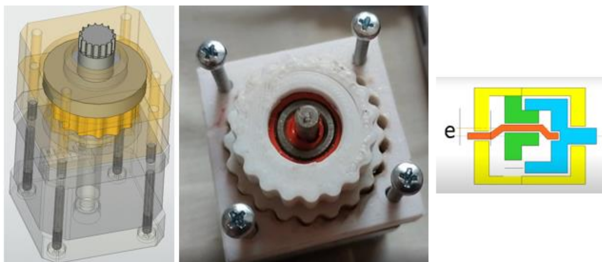
Рис. 2. Двухступенчатый циклоидальный механизм ( U=400 )
