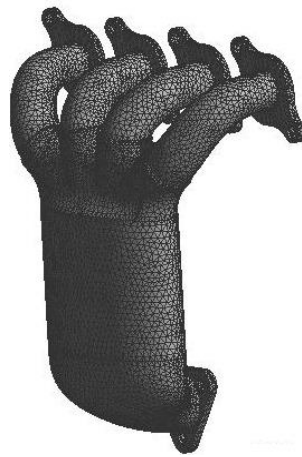
Рис. 5. Сетка конечных элементов корпуса каталитического коллектора
