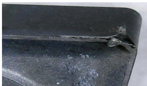
Рис. 1.Г. Износ пластины после обработки 1 режимом обработки, изометрия
