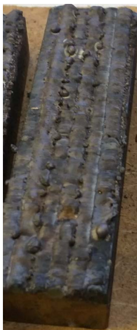
Рис. 3. Образцы после лазерной наплавки порошка бронзы оловянной ПР-БрОС-10-1,5: а – после лазерной обработки, б – после шлифовки
