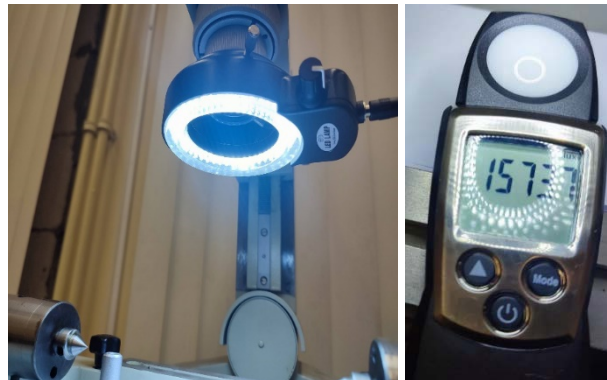
Рис. 4. Кольцевая диодная подсветка
