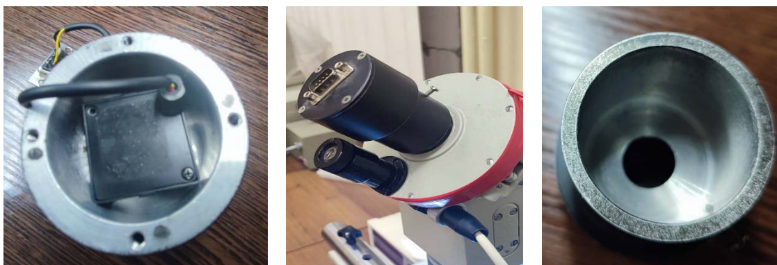
Рис. 5. Окуляр – камера от оптиметра горизонтального
