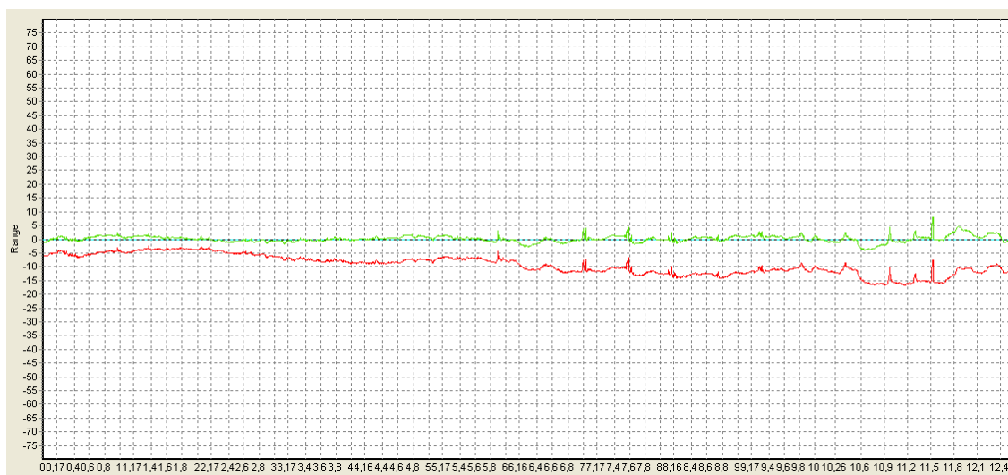
Рис. 4. График средней линии шероховатости на I режиме обработки (максимальные показатели шероховатости)
