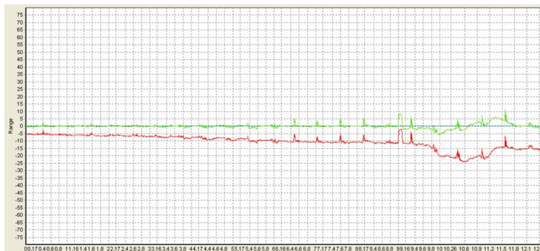
Рис. 10. График средней линии шероховатости на III режиме обработки (максимальные показатели шероховатости)
