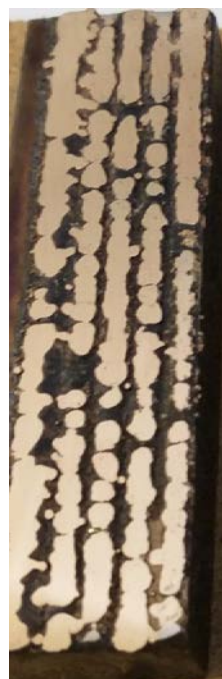
Рис. 3. Образцы после лазерной наплавки порошка бронзы оловянной ПР-БрОС-10-1,5: а – после лазерной обработки, б – после шлифовки
