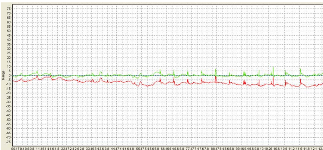
Рис. 8. График средней линии шероховатости на III режиме обработки (минимальные показатели шероховатости)
