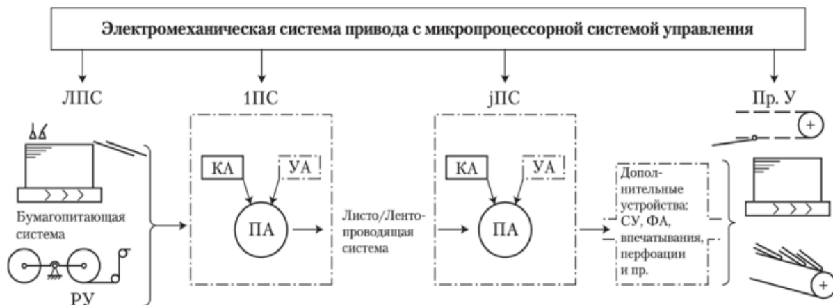
Рис. 1. Обобщённая схема печатной машины
