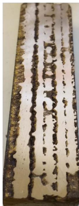
Рис. 4. Образцы после лазерной наплавки порошка бронзы-безоловянной ПР-БрАЖ9,5-1: а – после лазерной обработки, б – после шлифовки
