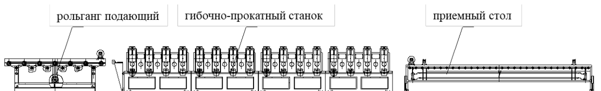
Рис. 3. Линия для производства опалубочного профиля
