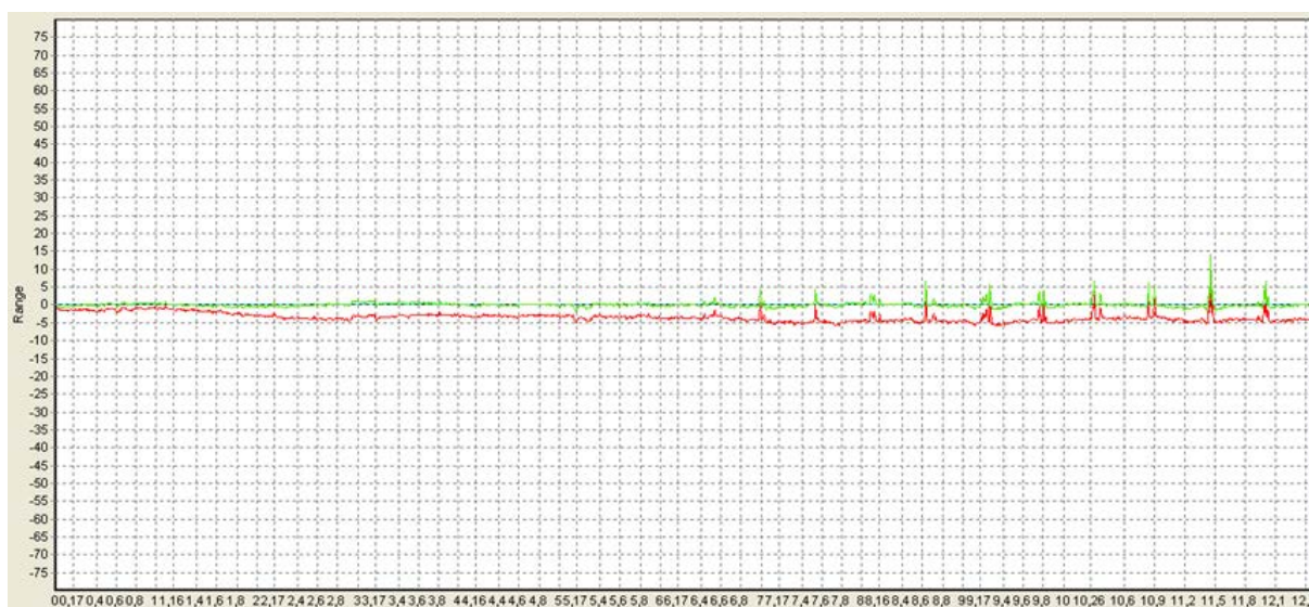
Рис. 5. График средней линии шероховатости на II режиме обработки (минимальные размеры вершин шероховатости)
