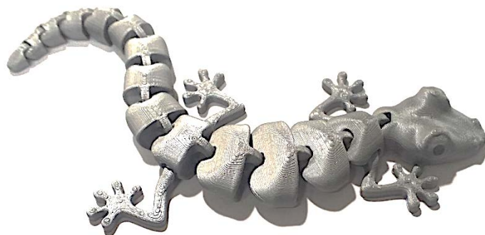
Рис. 2. Распечатанная модель геккона со встроенной RFIDметкой
