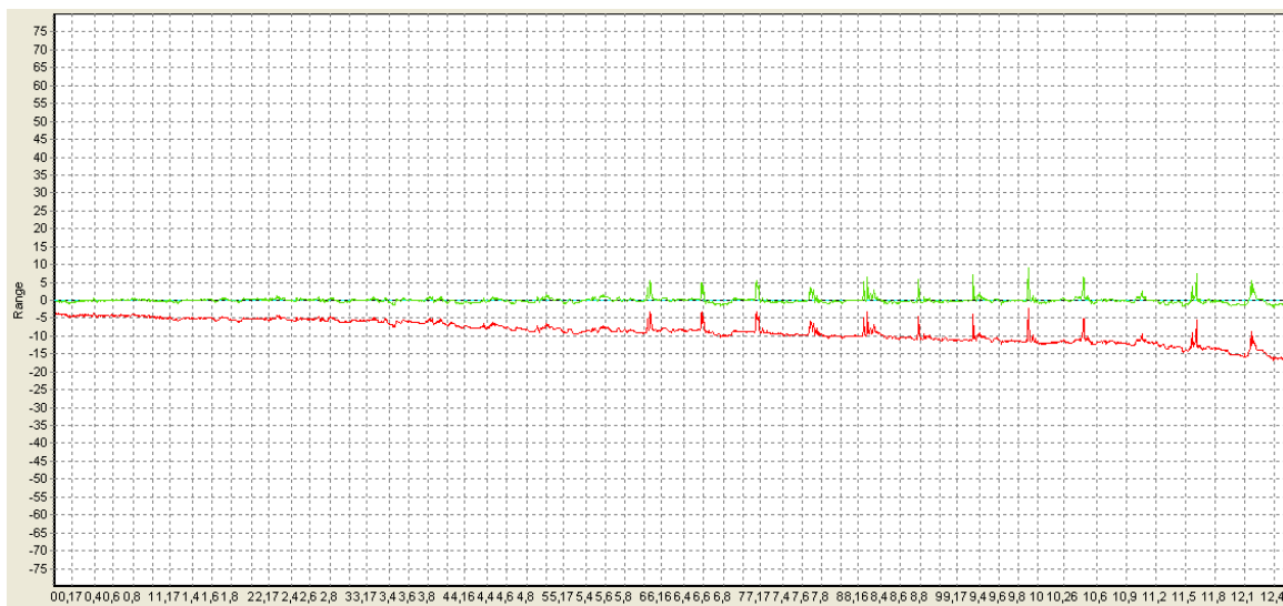
Рис. 3. График средней линии шероховатости на I режиме обработки (средние показатели шероховатости)
