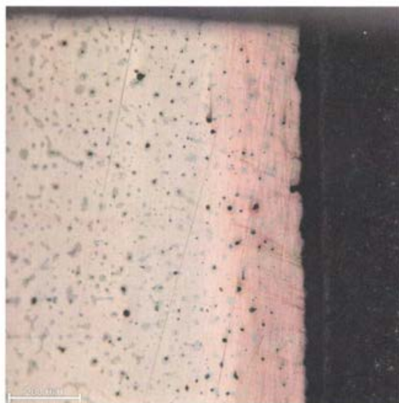
Рис. 4. Микрошлифы по месту непривара (Край башмаков). Неудовлетворительная подготовка поверхности бронзовых заготовок под диффузионную сварку
