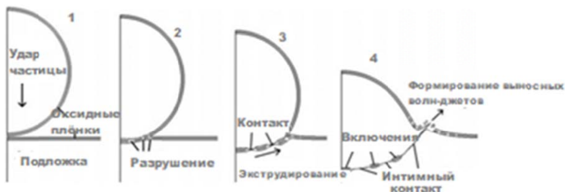
Рис. 1. схема процесса связывания частицы и подложки во время удара при холодном газодинамическом напылении, сопровождающаяся разрушением и экструдированием поверхностных оксидных пленок и образованием струй
