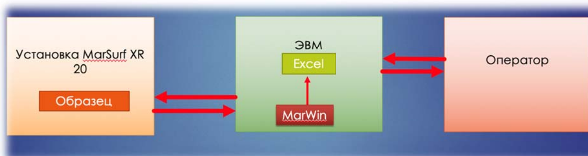
Рис. 2. Структурная схема для фрактального анализа шероховатости поверхности с применением установки MarSurf XR 20
