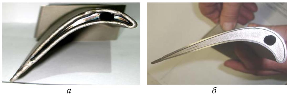
Рис. 6. Внешний вид данной лопатки после двухпроходной наплавки радиусного торца (а) и эрозионной обработки (б)
