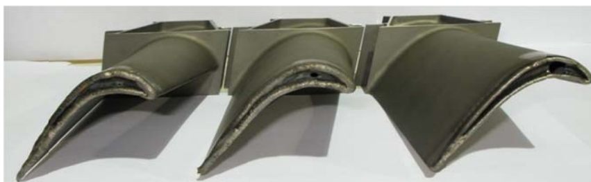
Рис. 5. Внешний вид лопаток после трехпроходной наплавки
