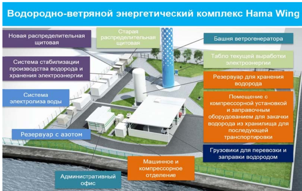
Рис. 1. Схема расположения основных объектов на ветряной электростанции и фабрике по производству водорода Hama Wing
