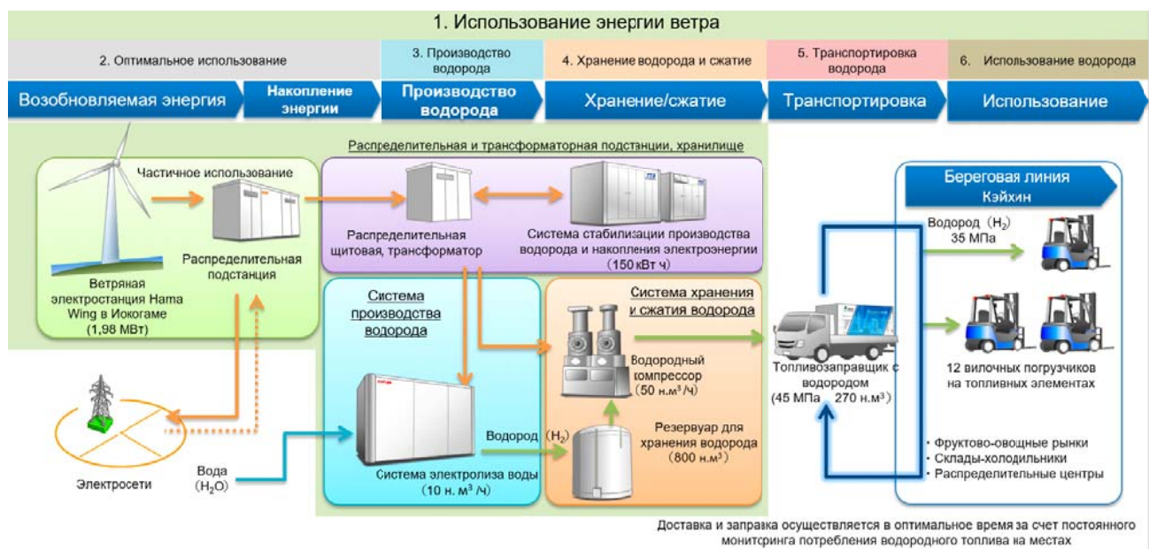
Рис. 2. Процесс производства, сжатия, хранения, транспортировки и использования водорода
